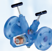
Purgadores de condensado con válvulas de aislamiento integradas CON A® "All-in-One" (Incluye: válvulas de corte, filtro interior, protección antiretorno, válvula de drenaje)
