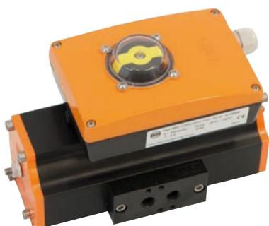
Esta robusta caja de interruptores de aluminio está indicada para el montaje directo de acuerdo con VDI/VDE 3845. Las diferentes configuraciones de panel posibilitan la instalación de varios tipos de microinterruptores e interruptores de proximidad.
