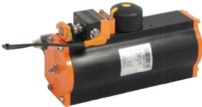
La conexión AS-I está disponible para todos los actuadores neumáticos modelo EB. Una electroválvula de bajo consumo energético (24V) es controlada a través del cable AS-i. La posición final es indicada a un sensor doble por un "puk".
